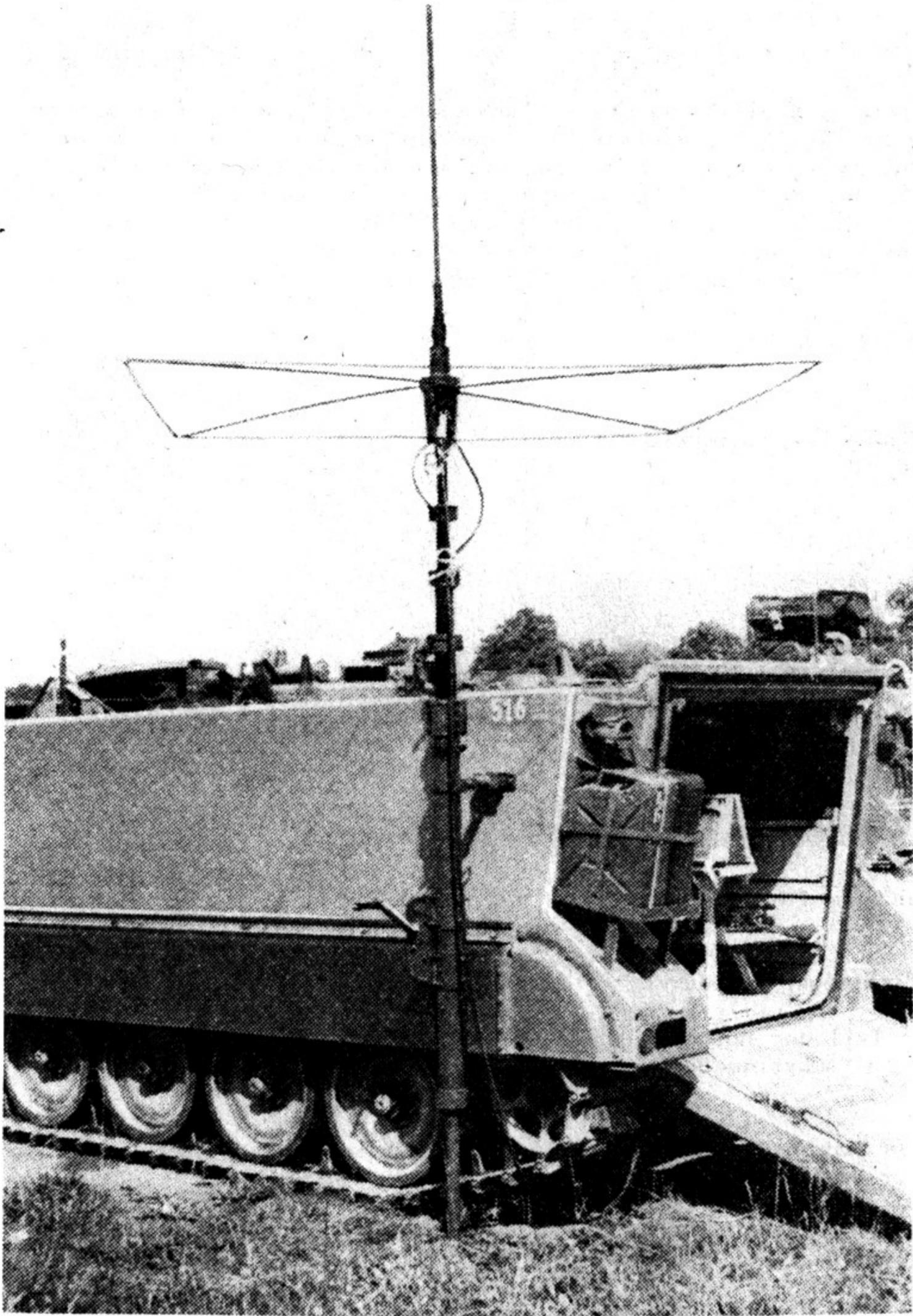
Fig 9 – Fernantenne FA-412 am Kdo Pz 63 aufgebaut (ohne Abspannung)
