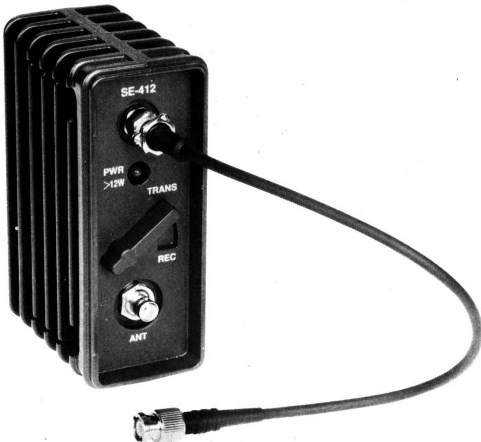
Fig 1 - Der ESM-Senderdämpfer (ED-412)
