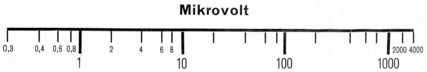
Fig. 4 Eichskala des Meßsender-Abschwächers
